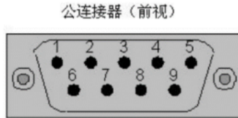
D 型连接器：2——TXD (发送数据) 3——RXD (接收数据) 5——地
